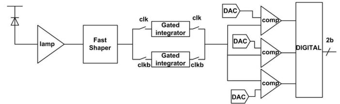
Fig. 5. PACIFICr2 Blocs diagram
